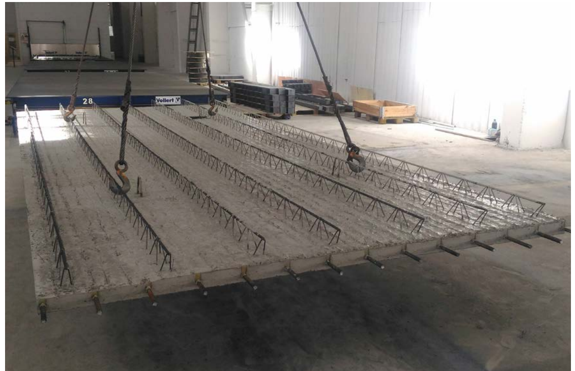
Пробная несъемная опалубка, произведенная на линии Vollert
