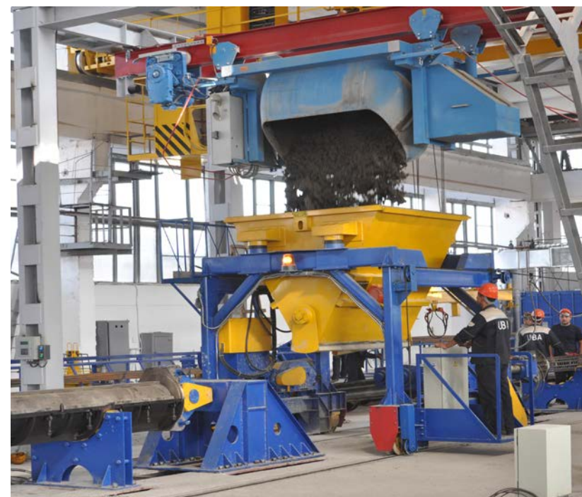
Загрузка бетона из кубеля в бетонораздатчик линии по производству опор контактной сети железной дороги
