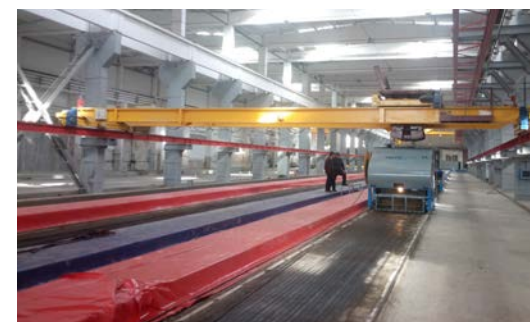
Линия безпалубочного формования Теспоспан
