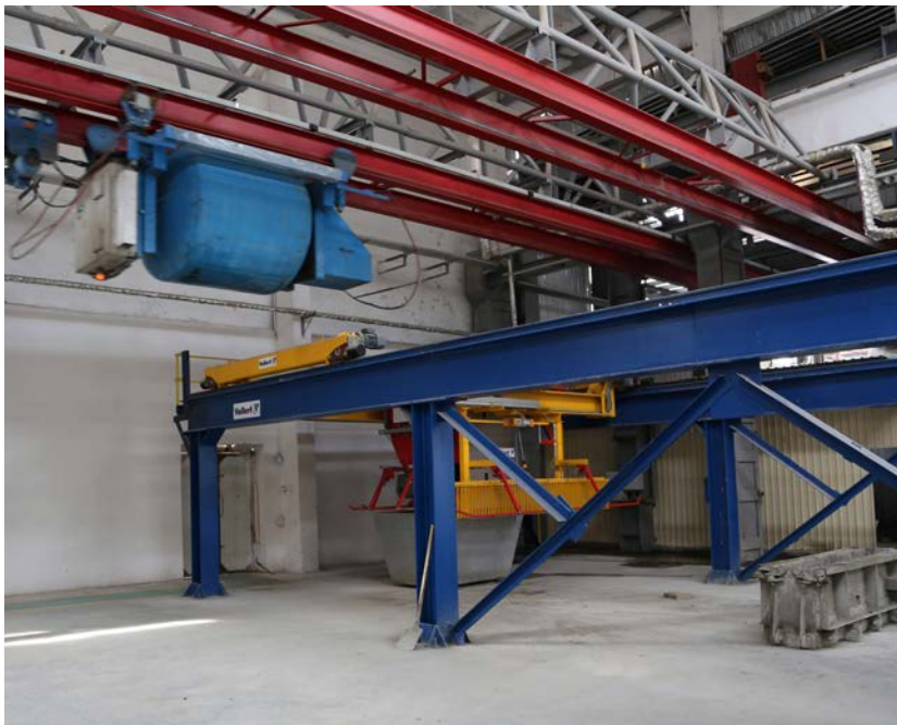
Работа крана адресной подачи Комкон синхронизирована с бетоноукладчиком Vollert
